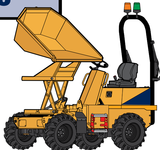
Mach 2071 - 2,0 toneladas giratorio con descarga en altura
